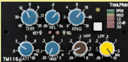
**Gegen null** TM116 Noise-Gate, extrem schnell, integrierte Filter, umfangreicher Parameter-Eingriff
