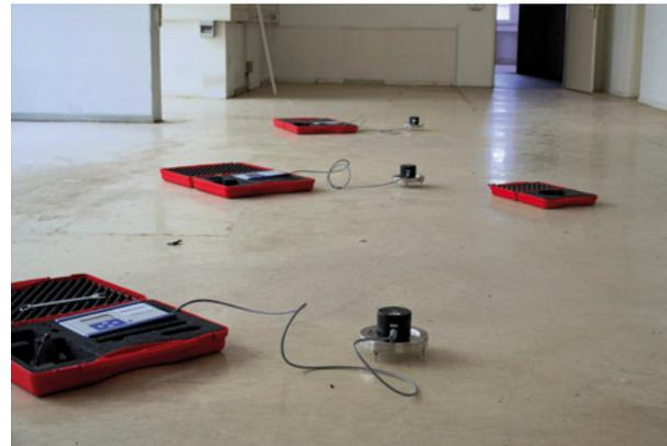
Messaufbau mit Schwingungsaufnehmern
