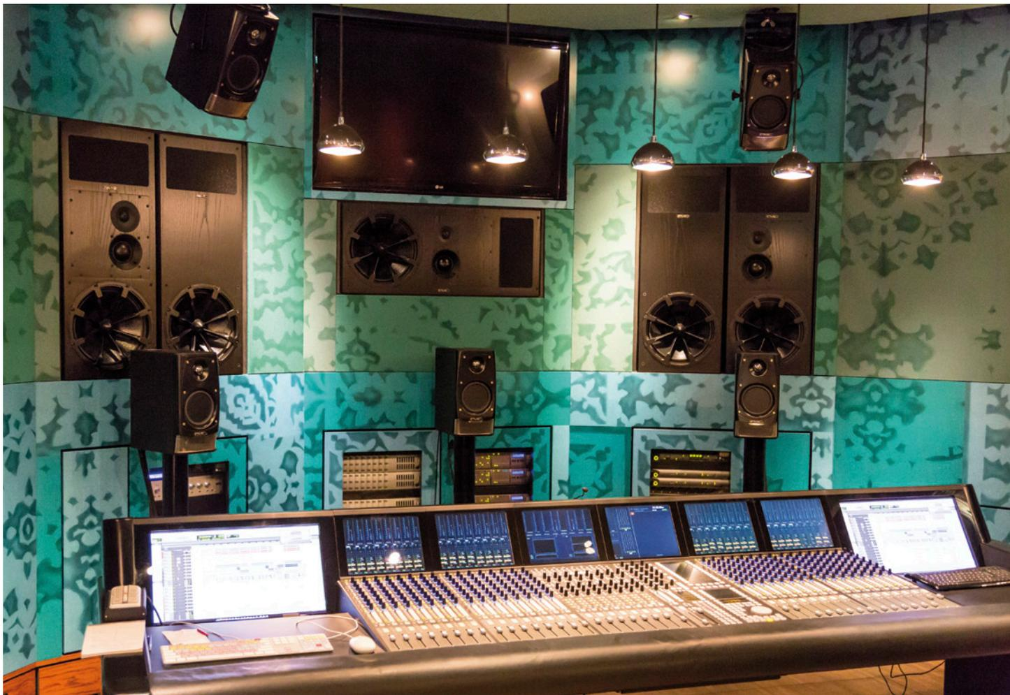
Das 9.1 Front-Setup mit PMC AML2 in Regie 1
