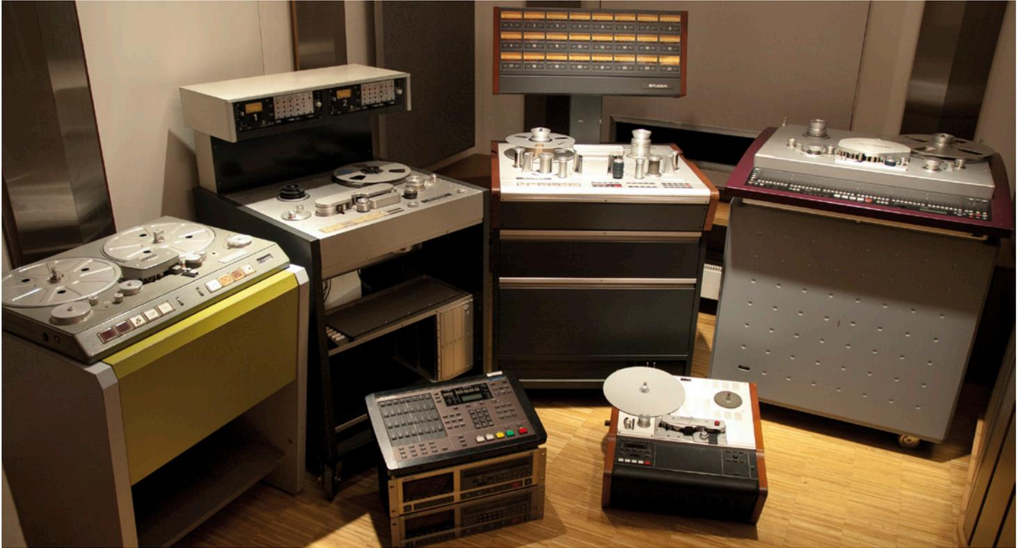
Vorbereitet auf alle Bandformate mit einem gut gepflegten Bandmaschinenpark. Rechts ein seltenes Stück: Die digitale 48 Spur DASH von Studer
