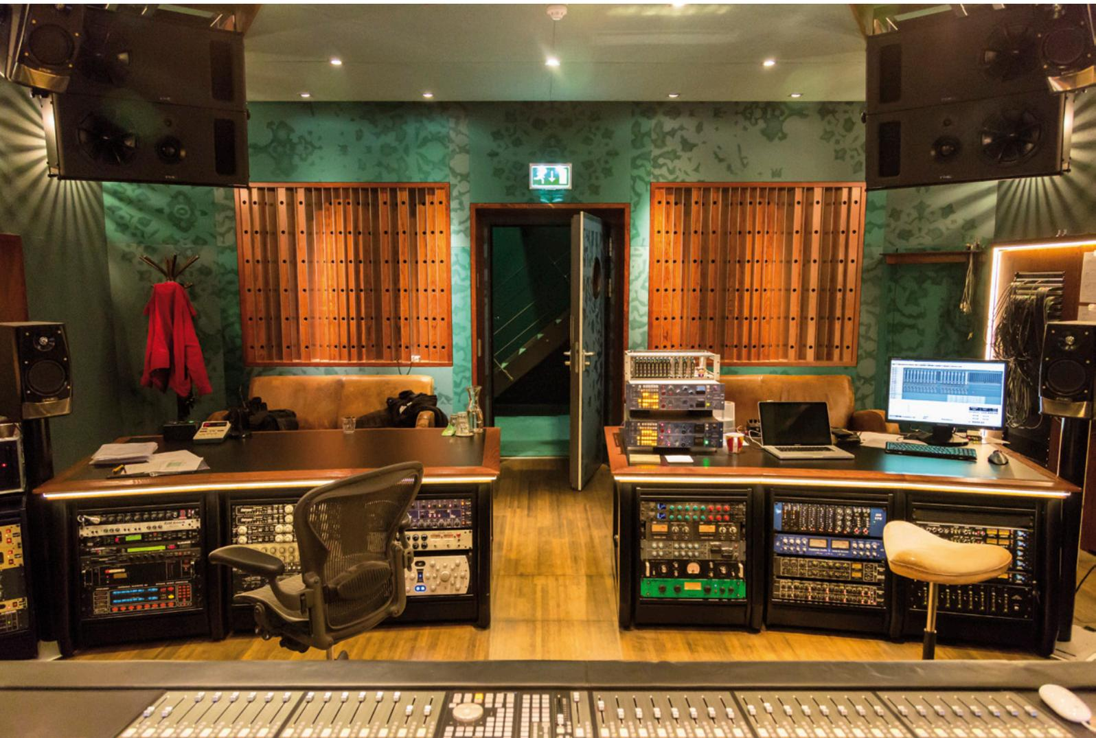
Blick auf das hintere 9.1 Setup mit PMC AML2 (ganz rechts und links, sowie rechts und links oben in den Ecken)
