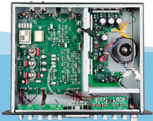
In der Innenansicht sind die zwei Übertrager vor und hinter dem Preamp, sowie die drei Röhren deutlich sichtbar
