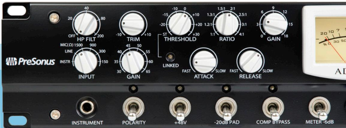
Die linke Geräteseite mit der Vorverstärker- und Kompressorsektion
