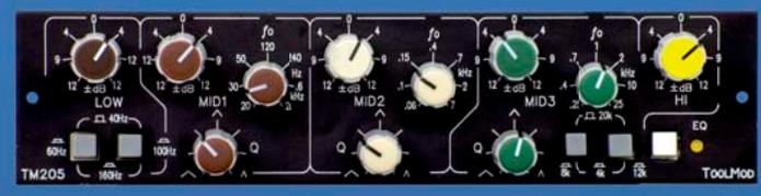
**TM205** der Stereo Mastering Equalizer mit 3 vollparametrischen Bänder für komplexe Bearbeitung von Stereosignalen.
